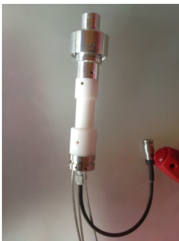
Abb.15 - Anpassungsschaltung mit Kunststoffgehäuse
