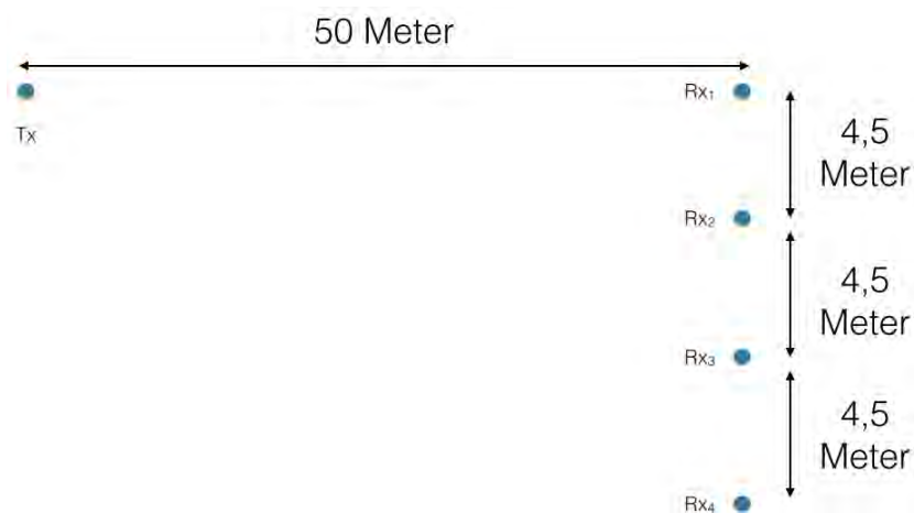
Abb.25 - Skizze des Messaufbaus
