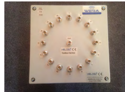
Abb.13 - Splitterbox der Firma Helzel
