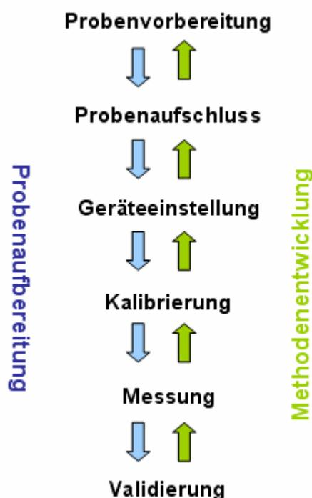
**Abbildung 7-1** Schema einer Methodenentwicklung
