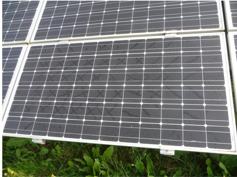
Abbildung 3.6: Schnecken Spuren auf einem monokristallinen Photovoltaikmodul. Quelle: (Eigenes Foto)
