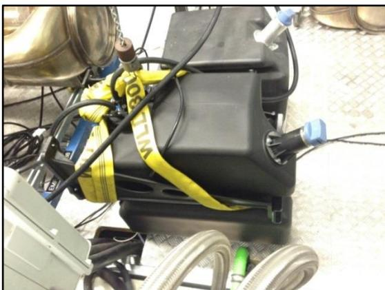
Abbildung 5-7: Harnstofftank im Prüfstand
