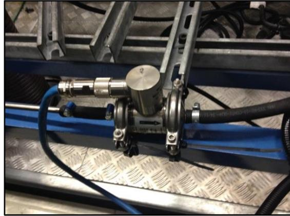
Abbildung 5-2: Messfühler mit Ultraschallkopf
