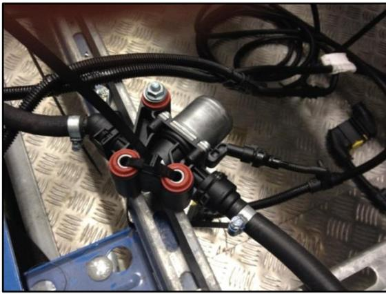
Abbildung 5-11: Magnetventil
