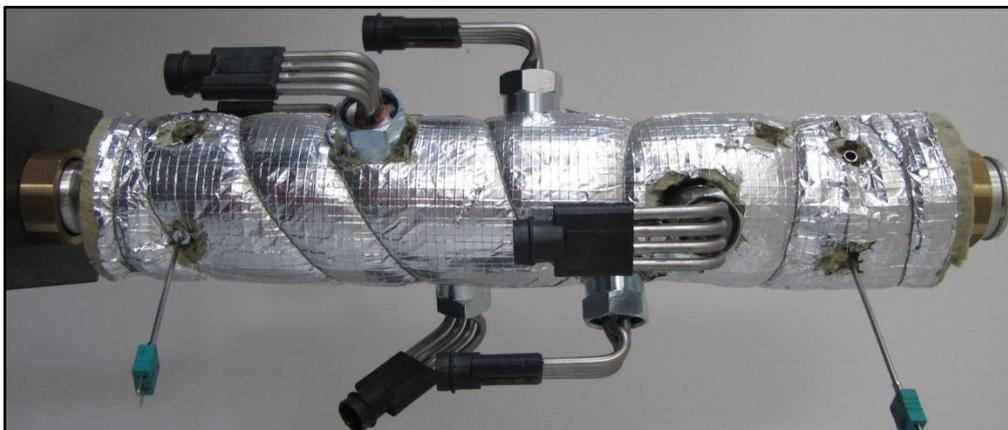
Abbildung 12-14: Wärmegeädämmte Druckleitung
