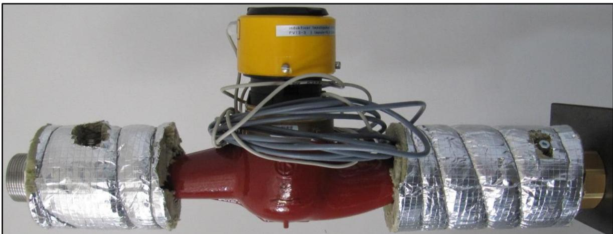
**Abbildung 12-19: Wärmegegedämmte Saugleitung**
