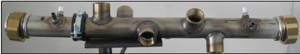
Abbildung 12-13: Druckleitung mit Messstellen und Einschraubstutzen
