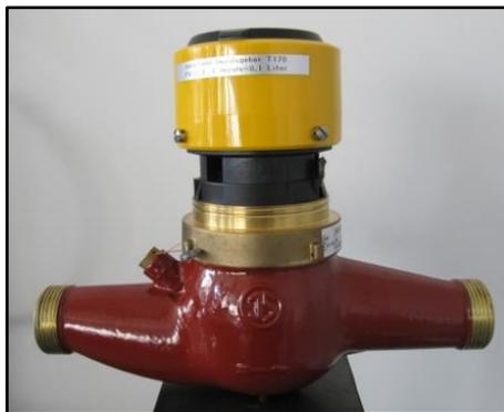
**Abbildung 12-16: Volumenstrommessuhr**
