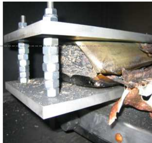
Abb. 16: Versuchsaufbau für die Überhitzung einer Li-Flachzelle (Wagner Group GmbH, 2010)
