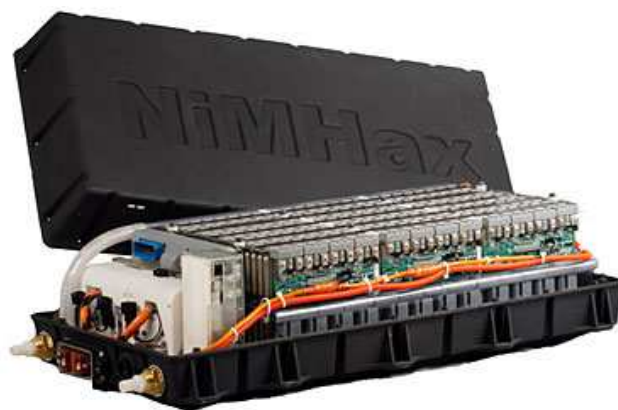
Abb. 5: NiMH-Batterie von der Fa. Cobasys für Toyota-Kraftfahrzeuge (yenra.com, 2004)
