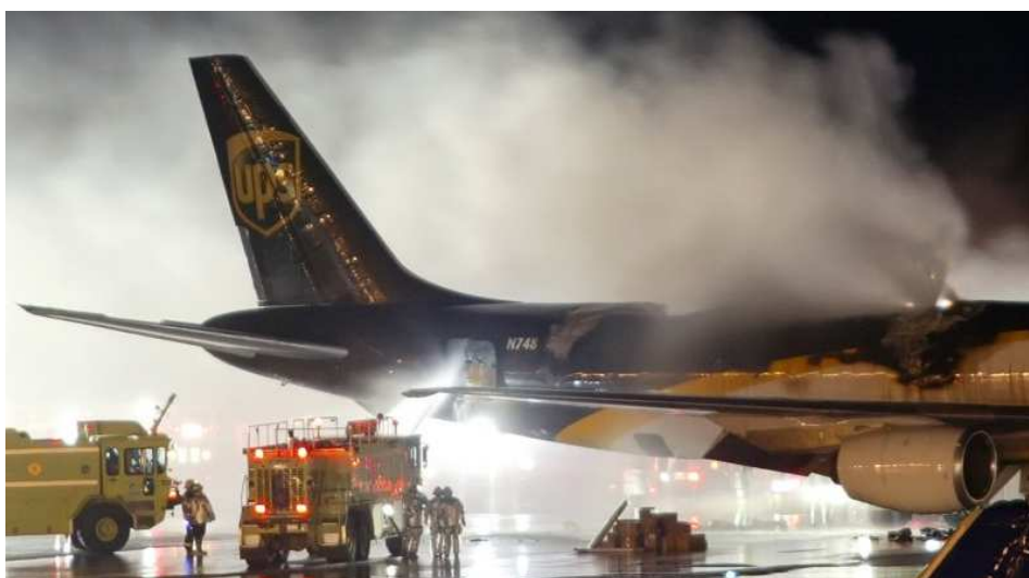
Abb. 24: Brand einer Frachtmaschine ausgelöst durch brennende Li-Batterien (Associated Press, 2013)
