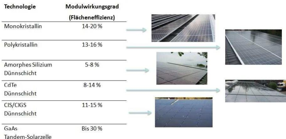
**Abbildung 2.7: Wirkungsgrade verschiedener Photovoltaik-Technologien**
