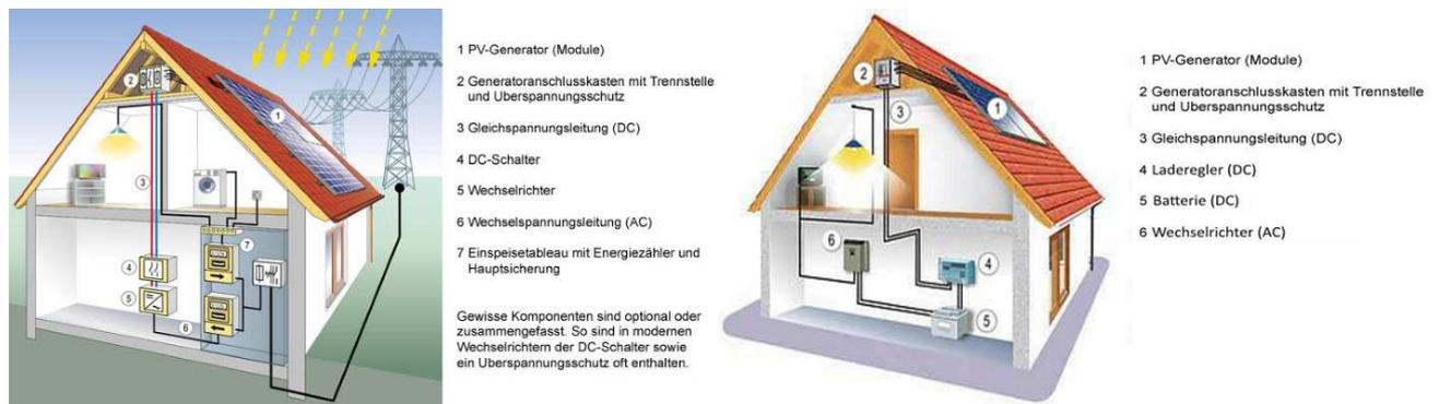
**Abbildung 2.13: Netzgekoppelte Anlage (links) und Inselanlage (rechts)**
