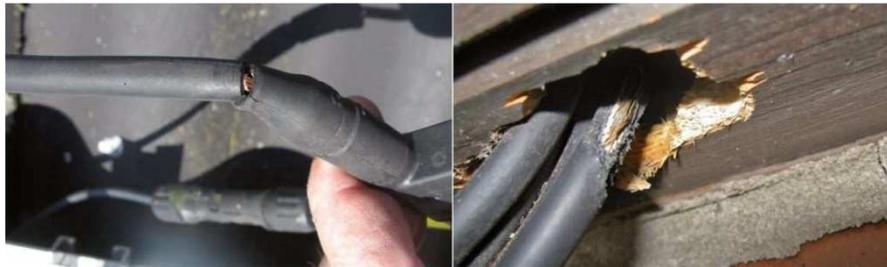
**Abbildung 3.4: Installationsmängel (Isolierung DC-Stecker, Leitungsverlegung)**
