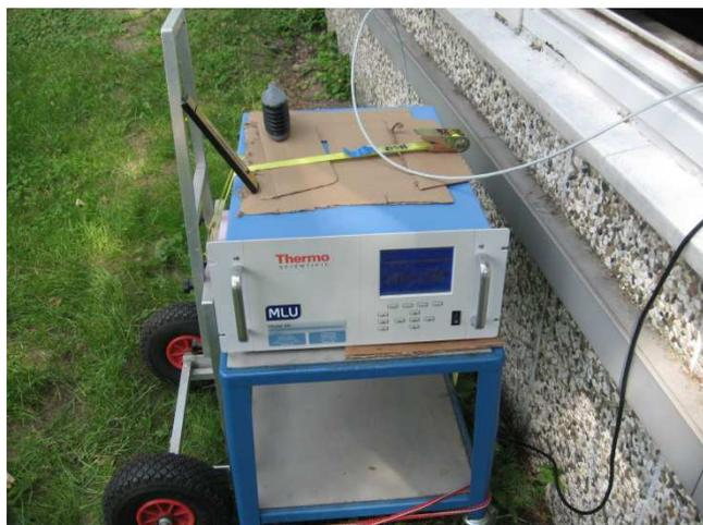
Abbildung 9: Ansicht des Messaufbaus zur Frischluftmessung von vorne. Zu erkennen sind das 49i und obenauf das Thermometer, sowie die Handpumpe des Dräger Messgeräts.
