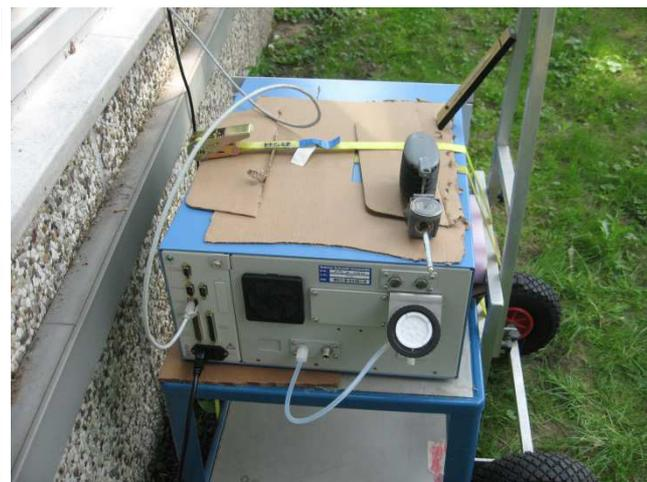
Abbildung 10: Ansicht des Messaufbaus von der Rückseite, zusätzlich zu erkennen sind der TCP/IP Anschluss, das Dräger Messröhrchen und der EingangsfILTER.
