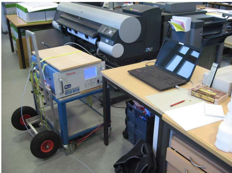
**Abbildung 7:** Foto des Messaufbaus. Zu sehen sind das 49i, der Laptop und das Thermometer (von links nach rechts)
