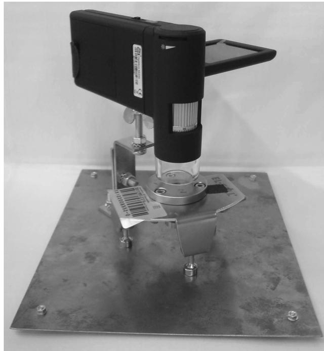
Abbildung 3.4.: Kamerahalter mit Kamera und Zellenhalter
