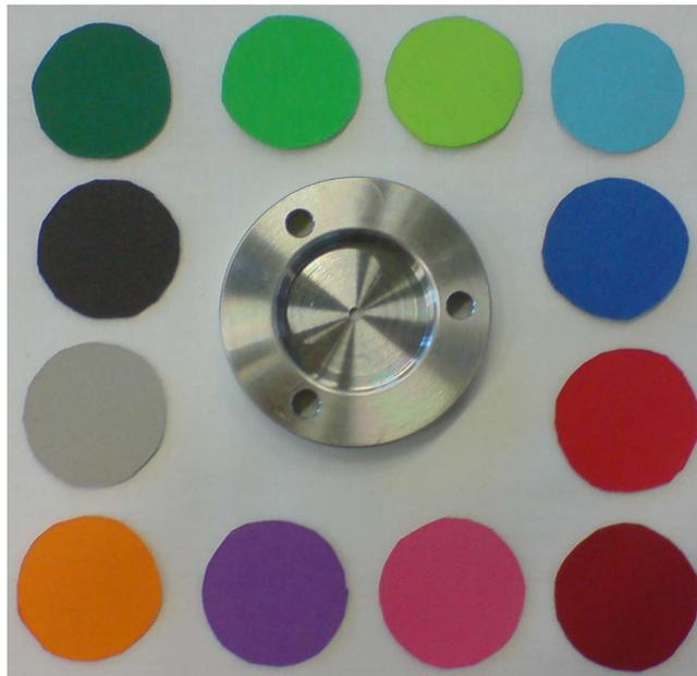
Abbildung 6.1.: Farbproben für spektrometrische Test-Messungen
