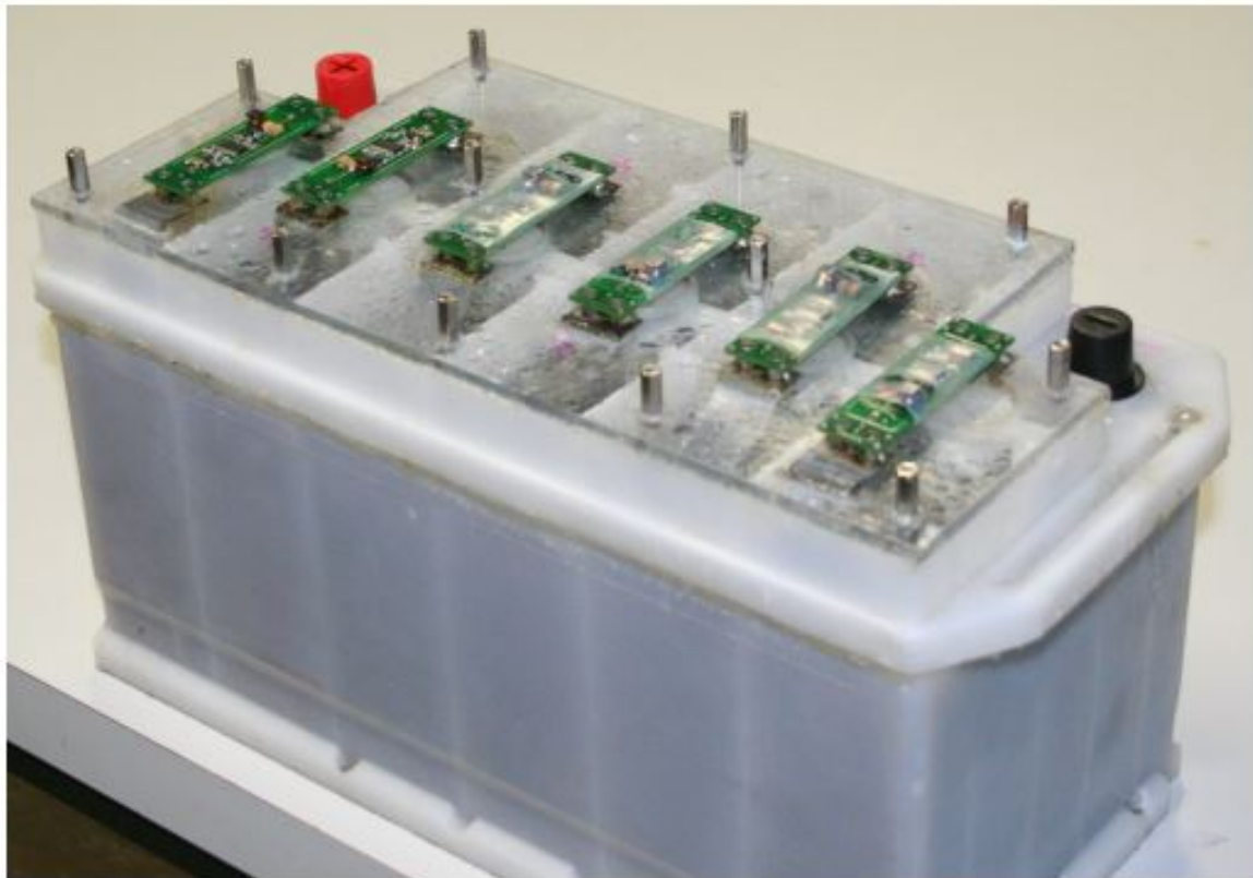
Abbildung 1.4.: Einsatz von Zellsensoren der Klasse eins in eine Starterbatterie. Die sechs Zellen werden getrennt überwacht. Zellspannung und Temperatur werden drahtlos an das Steuergerät übertragen und weiterverarbeitet [5]. Die Sensoren sind teilweise zum Schutz der Elektronik in Schrumpfschlauch gesichert.
