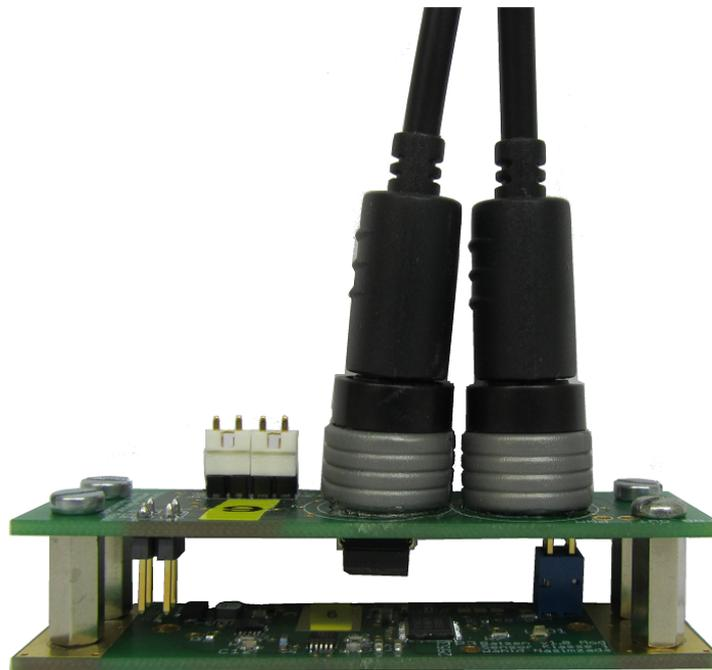
Abbildung 3.12: Beispiel eines Erweiterungsmoduls auf einem Zellsensor der Klasse 1 nach [55]
