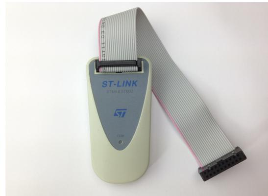
Abbildung 3.7.: Programmer von ST-Link
