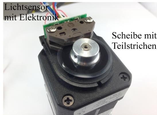
Abbildung 2.7.: Aufbau eines Encoders
