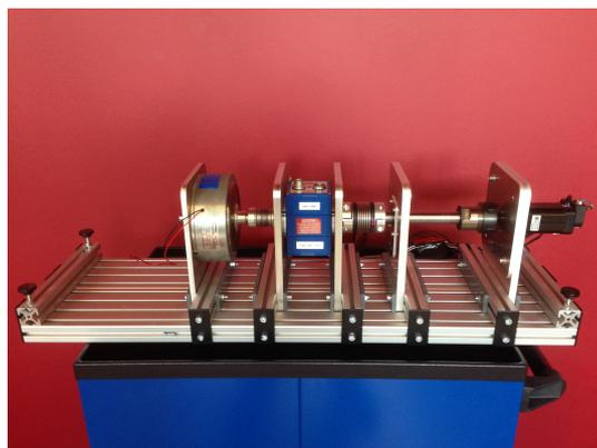
Abbildung 3.8.: Messstand des Drehmoments
