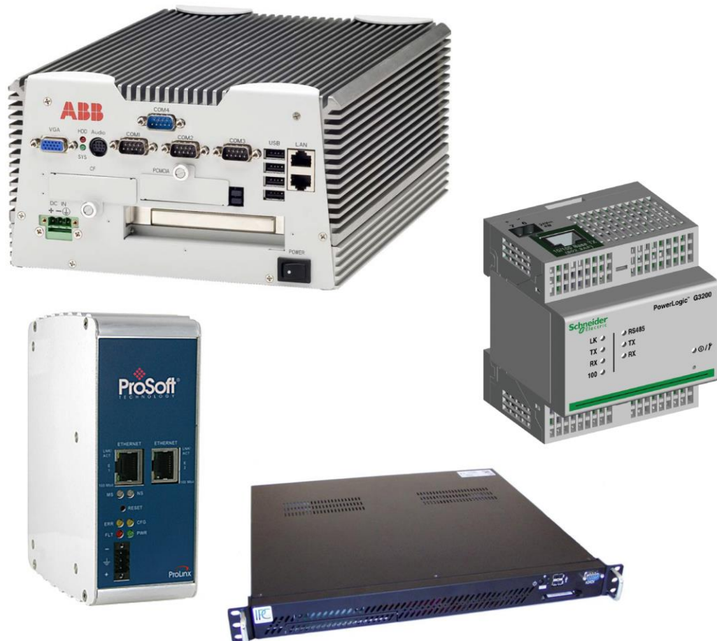
Abbildung 2.4: Verschiedene Modbus TCP/IP zu IEC61850 Gateways, der Preis liegt zwischen 700€ und 2500€
