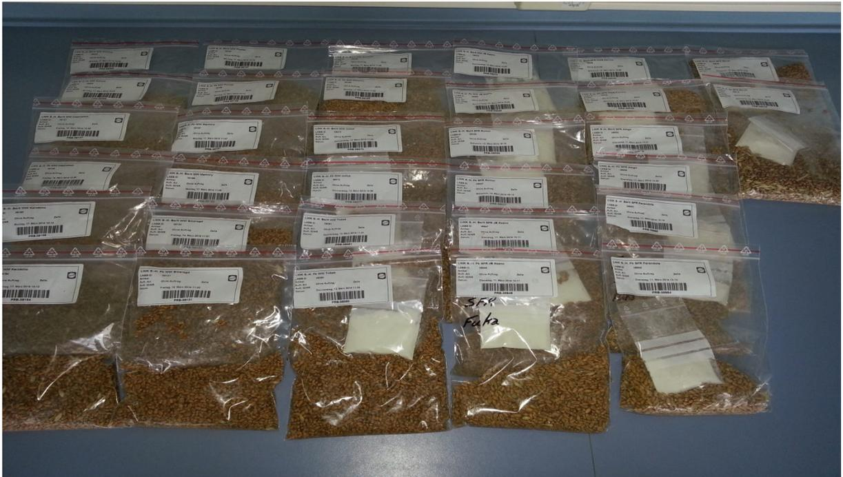
Anlage 3 stellt die Weizenproben dar. Von jeder Probe wurden ca.200 g zur Bestimmung des Sedimentationswertes aufbewahrt, da hier eine feinere Vermahlung nötig ist. Der Rest der Proben wurde in der Versuchsmühle vermahlen.
