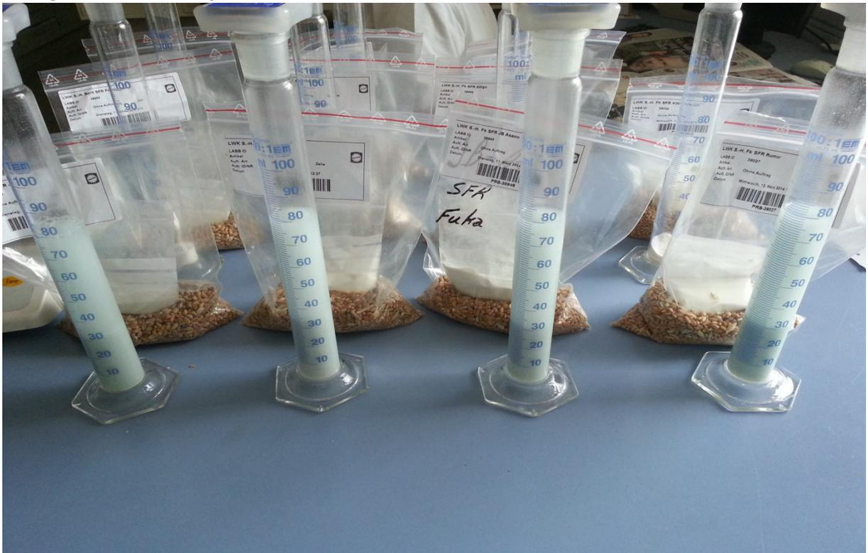
Im unteren Teil des Reagenzglases befindet sich das Sediment (dunkle Flüssigkeit), der Wert wird nach 5 Minuten abgelesen.
