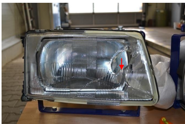
Abbildung 86: Beschädigung Zone 3 und 5
