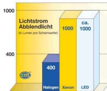
Abbildung 34 [6]: Lichtstrom Vergleich: LED / Xenon / Halogen
