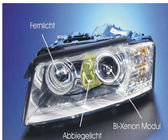
Abbildung 29 [6]: Abbiegelicht im Scheinwerfermodul
