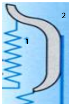
Abbildung 20 [7]: Glühlampe und Strahlenblende
