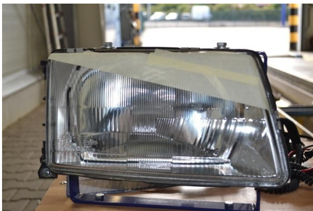
Abbildung 79: Abdeckung der Streuscheibe diagonal 25%
