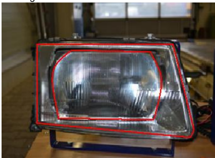
Abbildung 100: Abstrahlbereich eines Stufenreflektors
