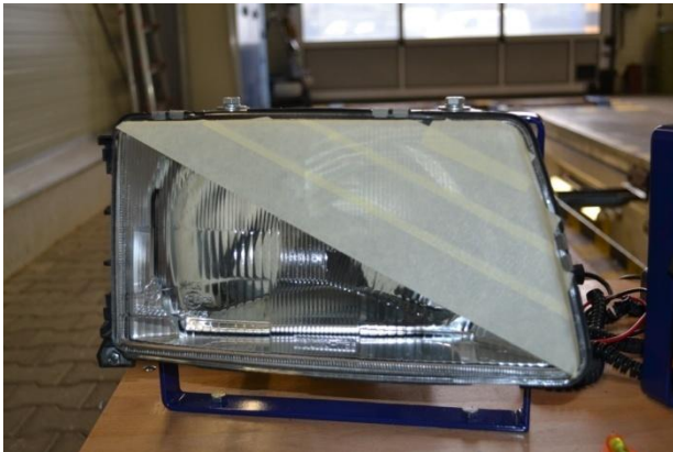
Abbildung 77: Abdeckung der Streuscheibe diagonal 50%
