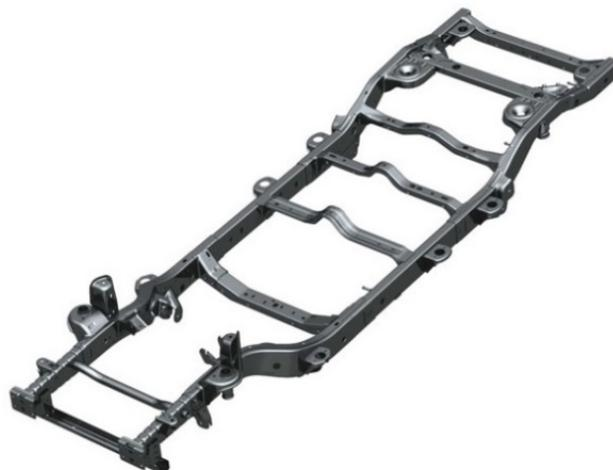
Abbildung 9: Leiterraahmen eines Lkw [TOW14]
