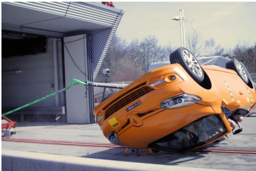
Abbildung 8: Rollover eines Cabriolets [ADA14]
