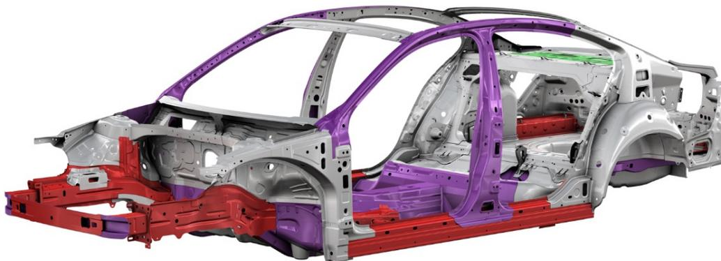
Abbildung 10: Karosserie in selbsttragender Schalenbauweise [MOT14]
