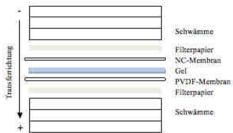
Abbildung 13: Schematischer Aufbau einer Blottingkammer für Western Blots. Die Proteine werden in einem senkrechten Aufbau vom SDS-Gel auf die PVDF-Membran übertragen. Dabei wandern die Proteine im elektrischen Feld in der Richtung der Anode und bleiben durch hydrophobe Wechselwirkungen auf der Oberfläche der Membran hängen. Bild: (Dorothea Plundrich, 2014)
