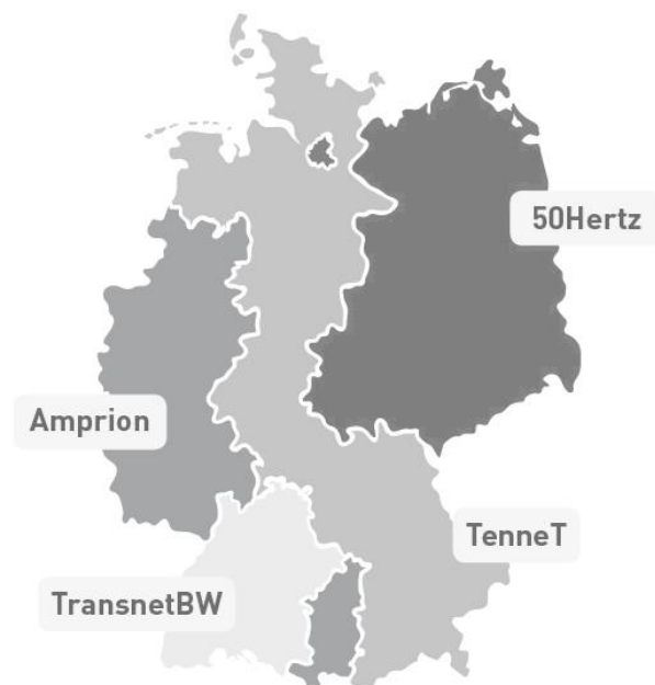
Abbildung 1: Regelzonen der vier deutschen Übertragungsnetzbetreiber (Netzentwicklungsplan, n.d.)
