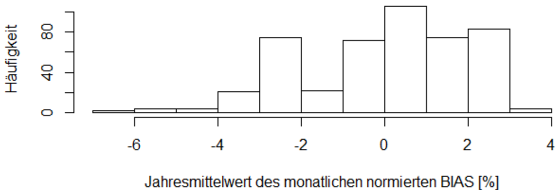
Abbildung 12: Häufigkeit der Jahresmittelwerte der monatlichen BIAS norm aller Wechselrichter (eigene Darstellung)
