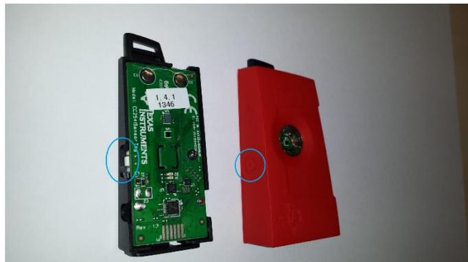
Abbildung 5.5: Seitlicher Knopf des SensorTag
