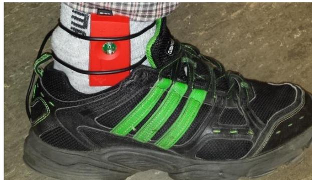
**Abbildung 6.1: SensorTag Position am Bein der Testperson**
