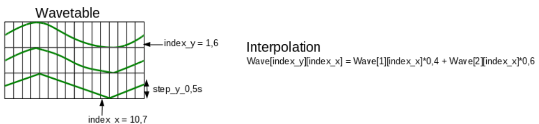
Abbildung 3.7.: Beispiel für die Schrittweiten und Interpolation bei einer Wavetable in y-Richtung
