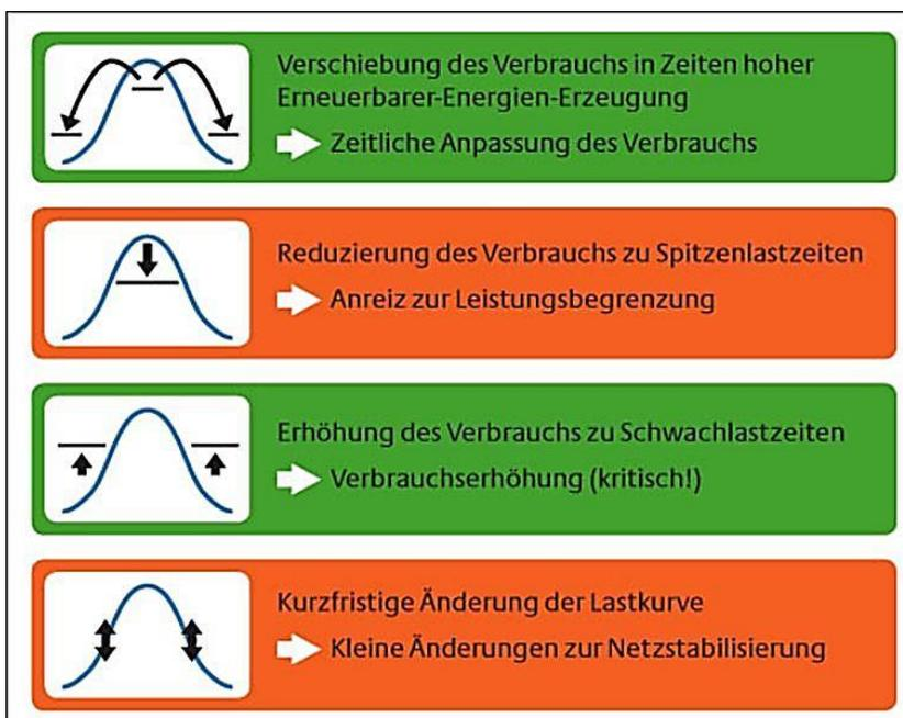
Abbildung 2.1: Lastverschiebearten im Rahmen des DSM [4]
