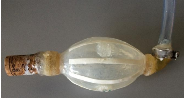
Abbildung 5: Modifizierte Pumpkammer P1. Die präparierte Pumpkammer wurde luft- und flüssigkeitsdicht verschlossen.
