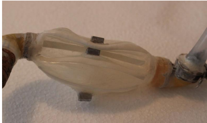
Abbildung 26: Durch einen niedrigen Innendruck verursachtes Aneinanderheften benachbarter Magnete
