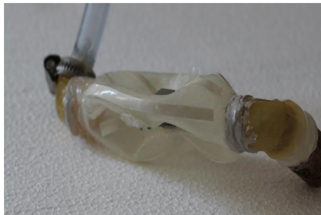
Abbildung 18: Kollabierter Zustand von P1, verursacht durch Anziehung der komplementären Magnetpolflächen
