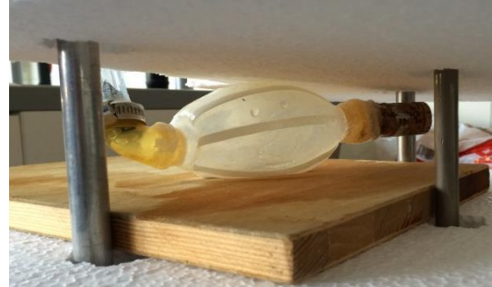
Abbildung 6: Künstliche Kontraktion von P1. Die Pumpkammer wird von oben zusammengedrückt und das vorher eingefüllte Wasservolumen in den Schlauch verschoben.
