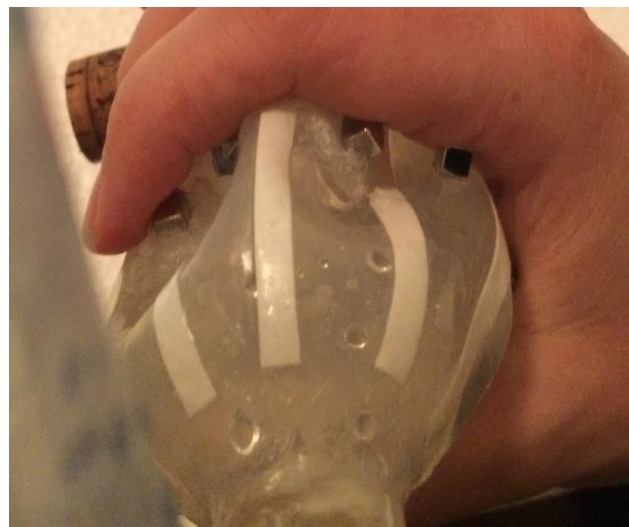
Abbildung 31: Händisch durchgeführte Kontraktion der Pumpkammer mit Rückstellsystem bei niedrigem Innendruck
