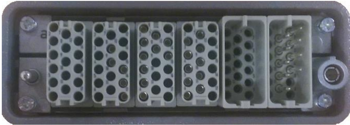
Abbildung 23: Universalstecker mit Mentholbesprühungsverdrahtung
