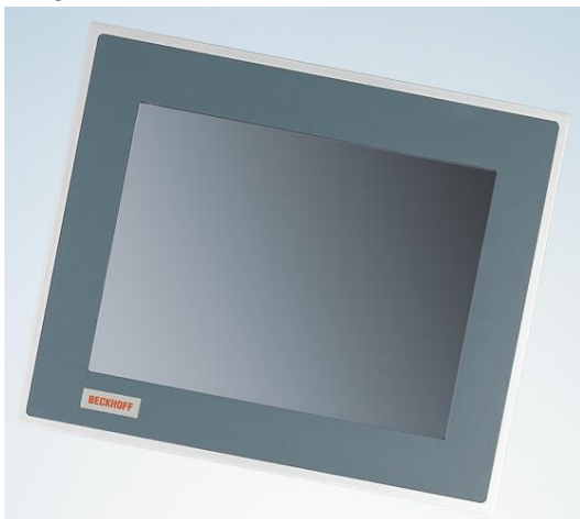
Abbildung 17: CP6707 - Panel-PC mit Touchbedienung und Soft-SPS [18]
