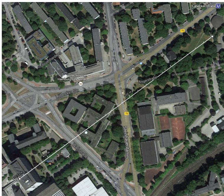
Abbildung 6.1: Getestete Reichweite des XBee Moduls. Maximal erreicht wurden 470m auf der markierten Strecke.
