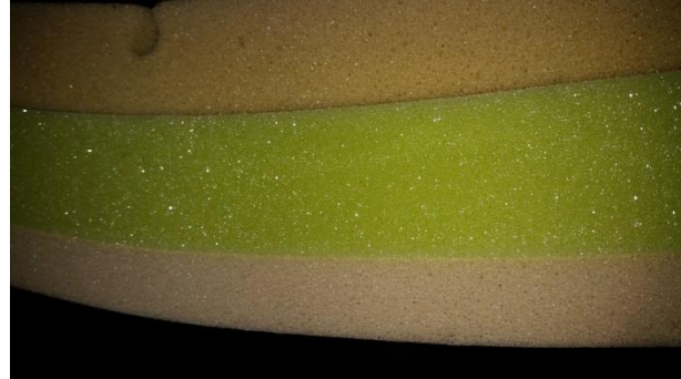
Abb. 4; Aufbau der Premium Comfort-Matratze aus unterschiedlichen Kaltschaumarten
