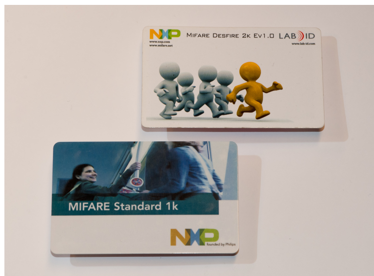
Abbildung 2: Zwei kontaktlose Chipkarten mit NXP MIFARE Technologie
