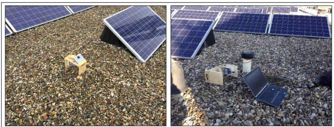
Abbildung 6.5: Sensorpositionierung auf dem Dach des Heizwerkes zur Ermittlung der direkten Globalstrahlung. Erste Messreihe mit Verschattung (rechts), folgende Messreihen ohne Verschattung (links). Die Verschattung löst sich gegen 10:00 Uhr auf.
