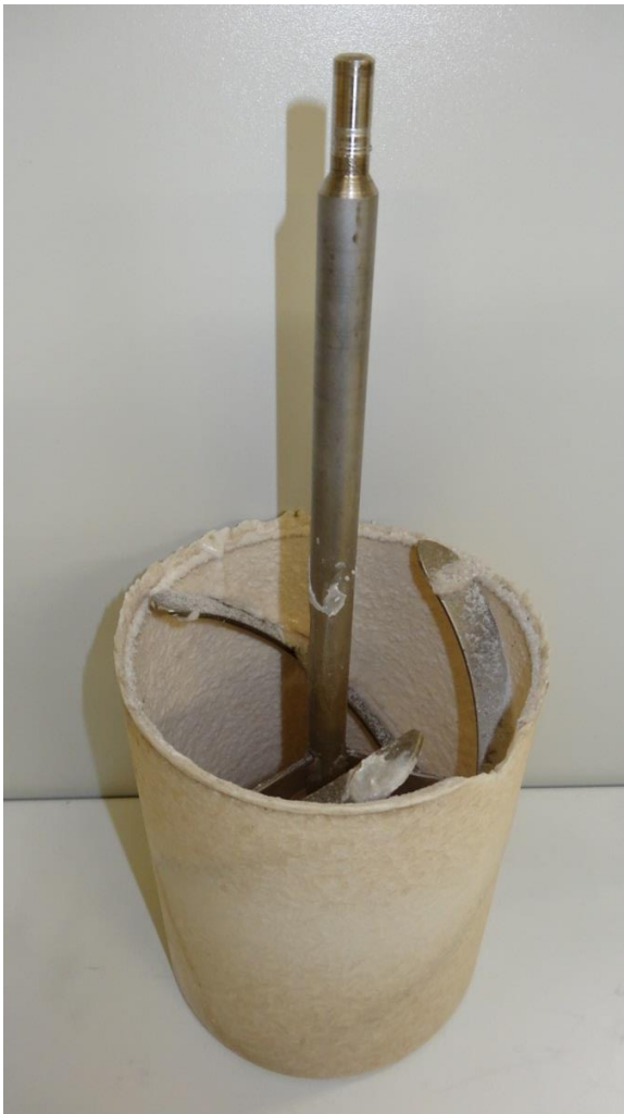
Abbildung 42 - PCM-Schichtdickenanalyse der kristallinen PCM-Schicht (links: PCM-Schicht mit Spindelrührer, rechts: Einfluss des Rührers auf die PCM-Schicht)
