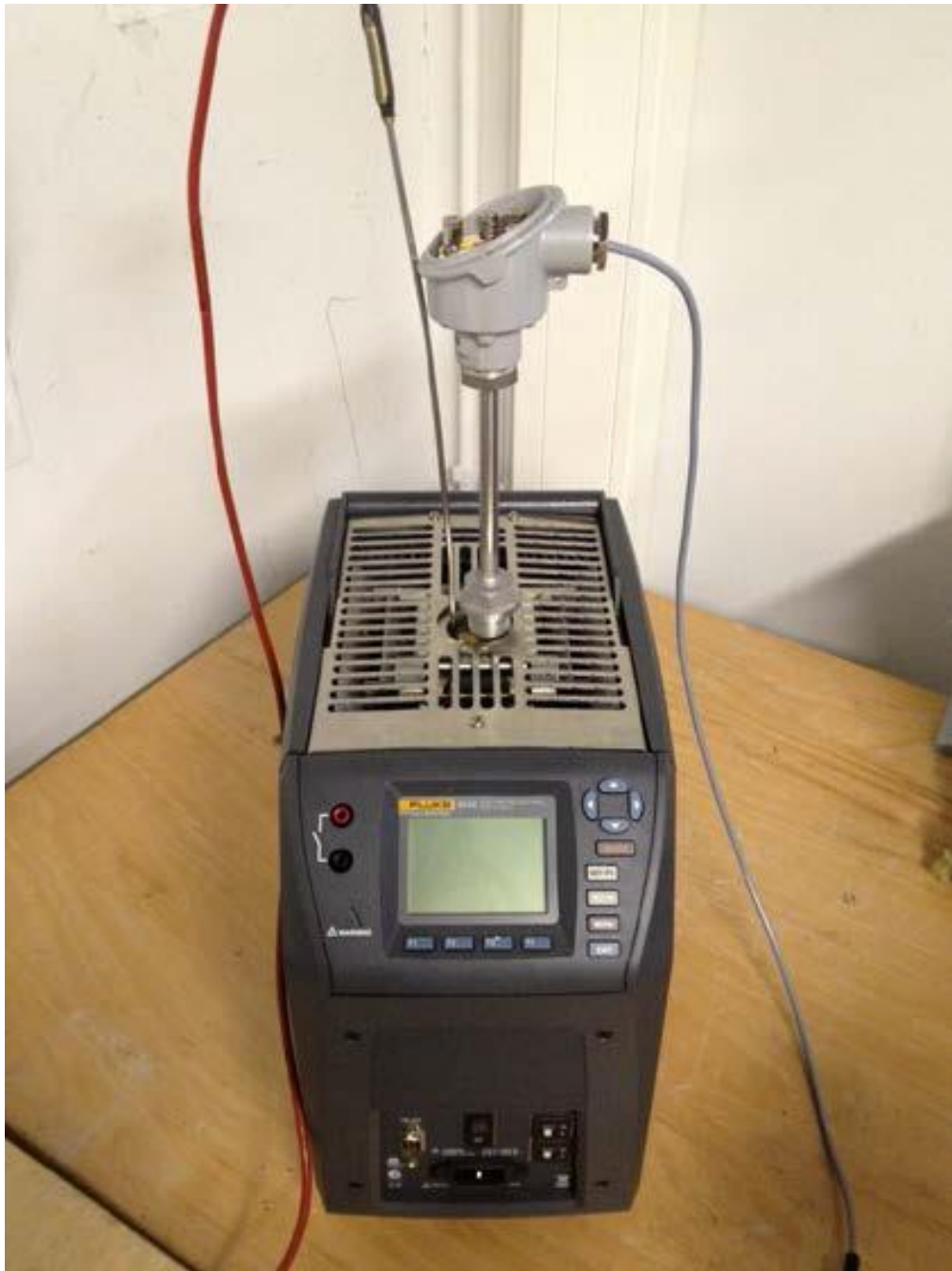
Abbildung 35 - Messaufbau der Kalibrierung mit Blockkalibrator, Referenzsensor und Kalibriersensor [34]
