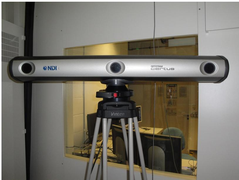
Abbildung 3.3: In der Abbildung ist der Positionssensor die Optotrak Certus, als ein Teil des Gesamtmesssystems, auf einem Stativ zu sehen. Der Positionssensor besteht aus drei einzelnen Kameras. Die äußeren beiden Kameras sind leicht angewinkelt. Dadurch kann die Optotrak Certus einen größeren aber gleichzeitig auch lückenlosen Messbereich erfassen.
