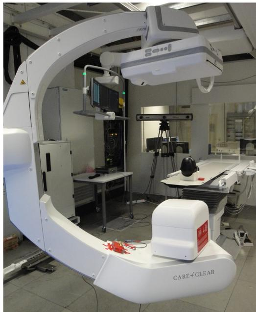
Abbildung 5.1: Im Vordergrund ist der C-Bogen des Artis zeego zu erkennen. Auf diesem sind drei Marker des Optotrak-Systems befestigt. Um eine kontinuierliche Sichtbarkeit der Marker bei gleichzeitigem großvolumigen Abfahren der Trajektorien zu gewährleisten, wird der Positionssensor (Hintergrund, Mitte) möglichst weit vom C-Bogen positioniert.
