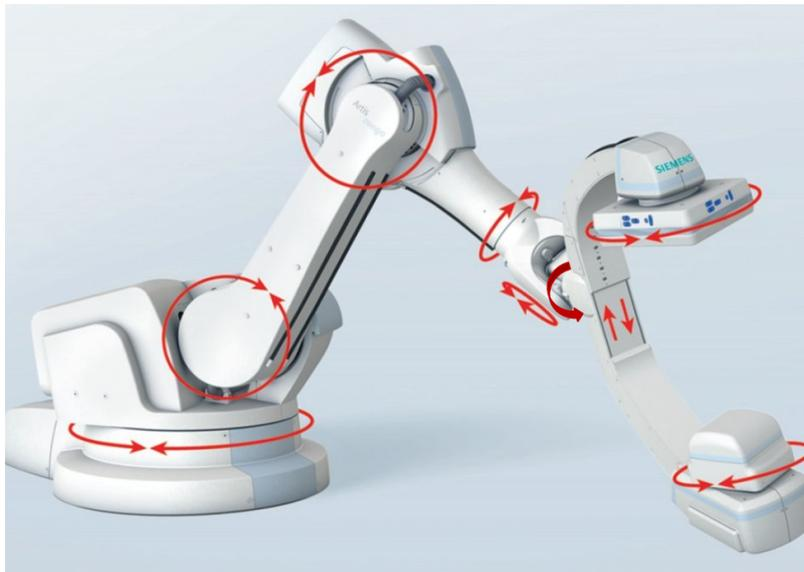
Abbildung 3.1: Zu sehen sind die verschiedenen Achsen des Artis zeego, die ein hohes Maß an Flexibilität ermöglichen [3].
