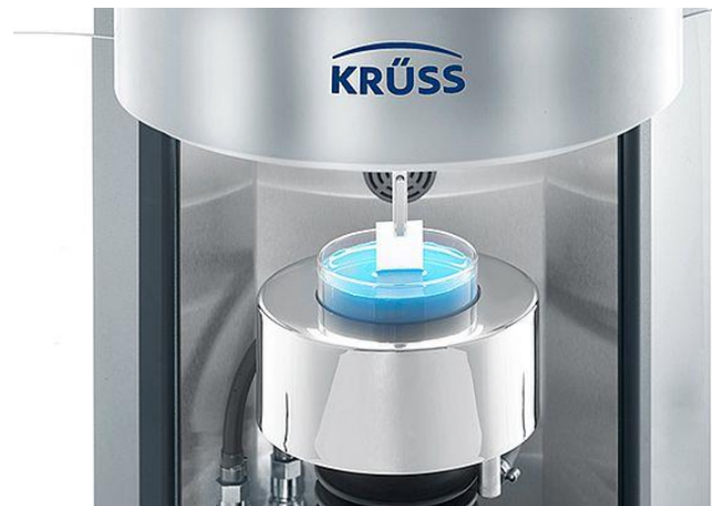
Abbildung 35: K100 Tensiometer, eintauchen der Messplatte 43
