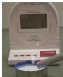
Abbildung 19: Zündung des Dampf-Luft-Gemisches
