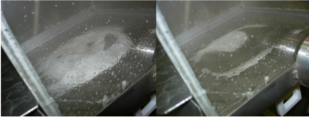
Abbildung 29: Erhöhte Standzeit des Schaumes auf der metallischen Oberfläche
