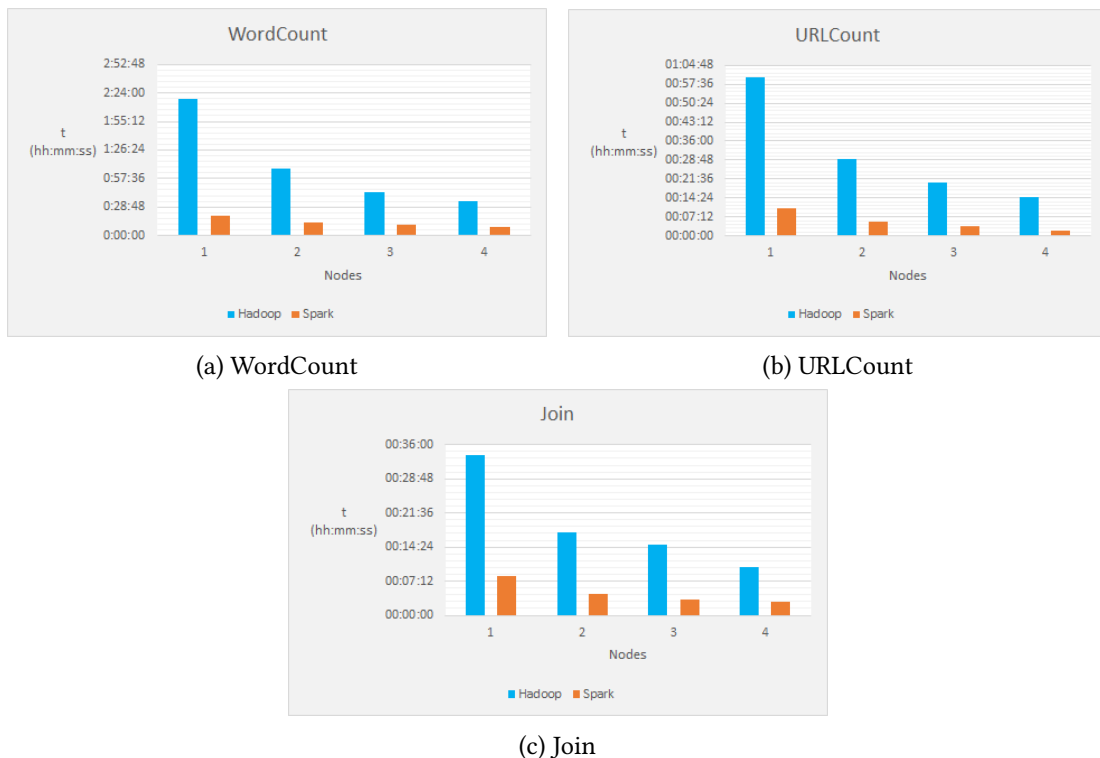
Abbildung 6.13: Vergleich der Ausführungszeiten von Apache Hadoop und Apache Spark bei Skalierung der Nodes mit den Operationen WordCount, URLCount und Join (Quelle: Vom Ganglia-Monitor erstellte Clustermetriken)
