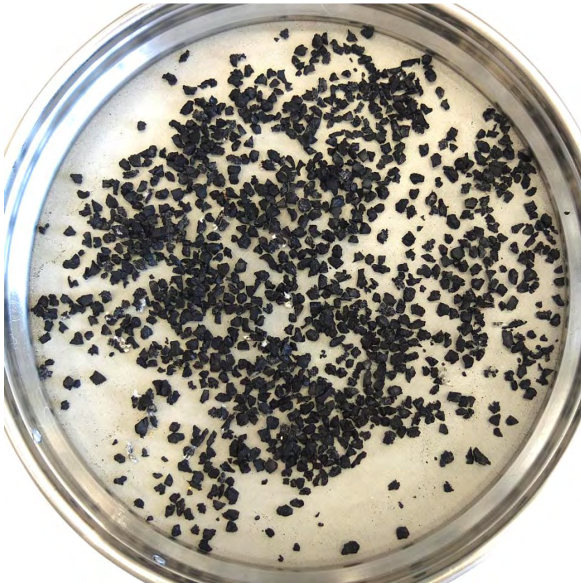
Abbildung 48: getrocknetes Material auf Sieben; Flotation des Grobgranulats; Versuchsreihe mit verschiedenen Konzentrationen an Tensid; (Tensidkonzentration 0,0405 g/l)
