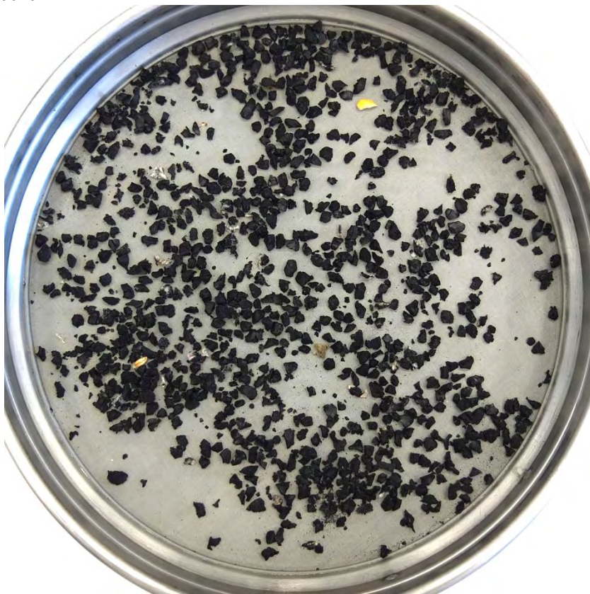
Abbildung 52: getrocknetes Material auf Sieben; Flotation des Grobgranulats; Versuchsreihe mit verschiedenen Volumenströmen des Druckwassers ohne Vorbenetzung durch Ethanol (Volumenstrom: 0,465 l/min)
