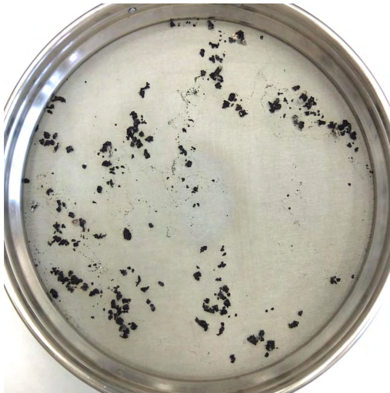
Abbildung 60: getrocknetes Material auf Sieb; Flotation des Grobgranulats; Versuchsreihe zur Verweilzeit; Schaumprodukt 3 entstanden zwischen 6 und 11 Minuten
