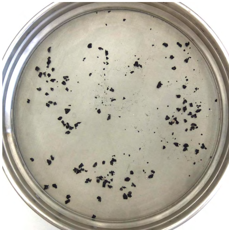
Abbildung 61: getrocknetes Material auf Sieb; Flotation des Grobgranulats; Versuchsreihe zur Verweilzeit; Schaumprodukt 4 entstanden zwischen 11 und 21 Minuten
