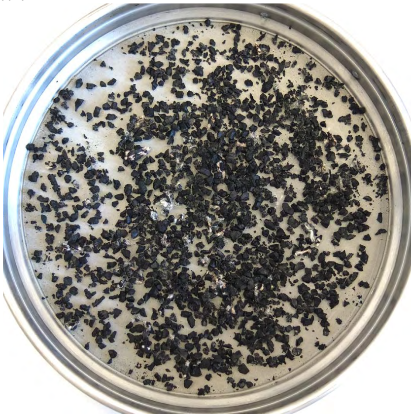
Abbildung 57: getrocknetes Material auf Sieben; Flotation des Grobgranulats; Versuchsreihe mit verschiedenen Überdrücken des Druckwassers (Überdruck: 4,4 bar)
