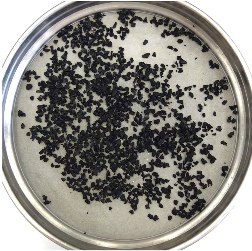
Abbildung 62: getrocknetes Material auf Sieb; Flotation des Grobgranulats; Versuchsreihe zur Verweilzeit; Rückstand nach 21 Minuten
