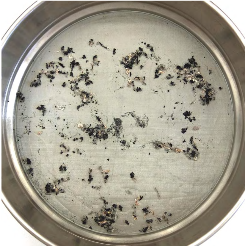
Abbildung 58: getrocknetes Material auf Sieb; Flotation des Grobgranulats; Versuchsreihe zur Verweilzeit; Schaumprodukt 1 entstanden zwischen 0 und 3 Minuten
