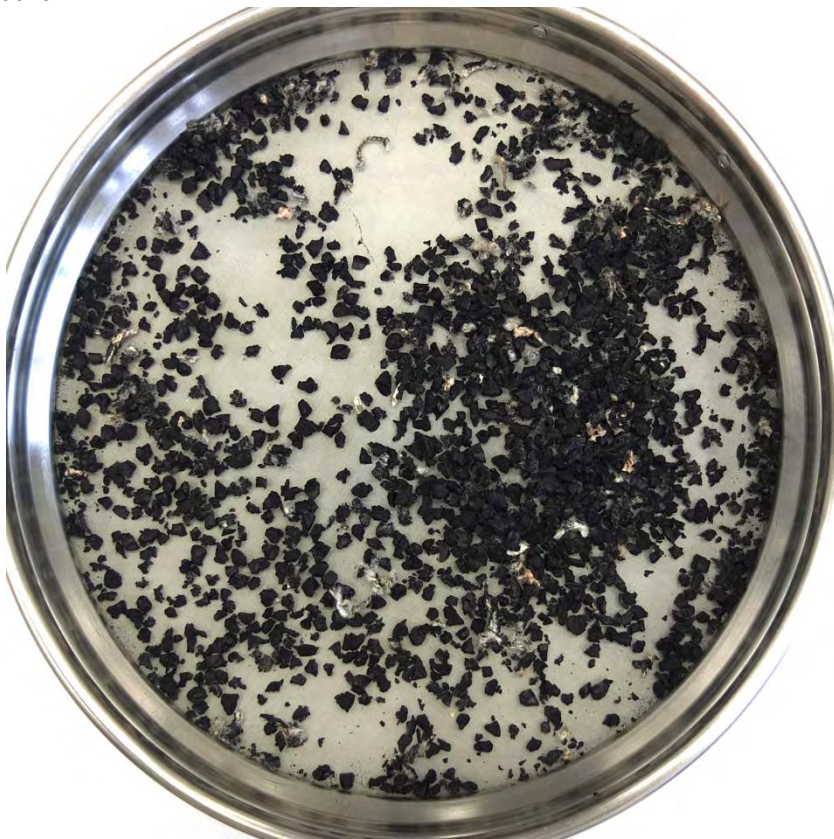
Abbildung 49: getrocknetes Material auf Sieben; Flotation des Grobgranulats; Versuchsreihe mit verschiedenen Volumenströmen des Druckwassers (Volumenstrom: 0,465 l/min)
