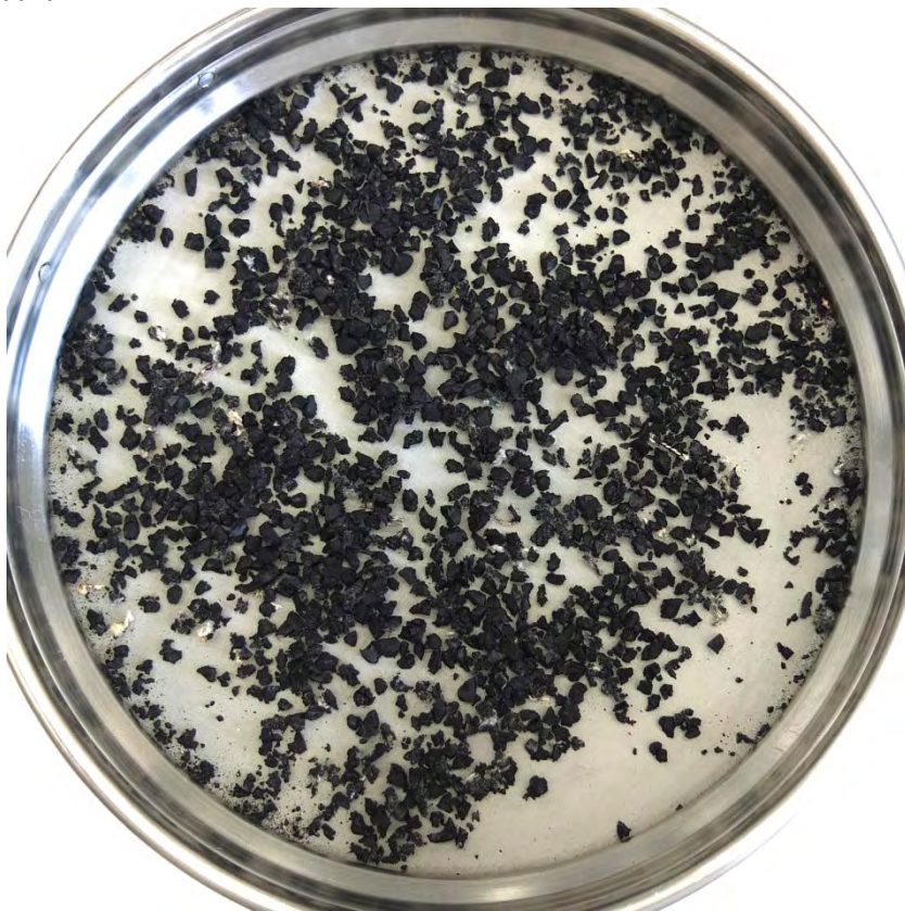
Abbildung 55: getrocknetes Material auf Sieben; Flotation des Grobgranulats; Versuchsreihe mit verschiedenen Überdrücken des Druckwassers (Überdruck: 3,2 bar)
