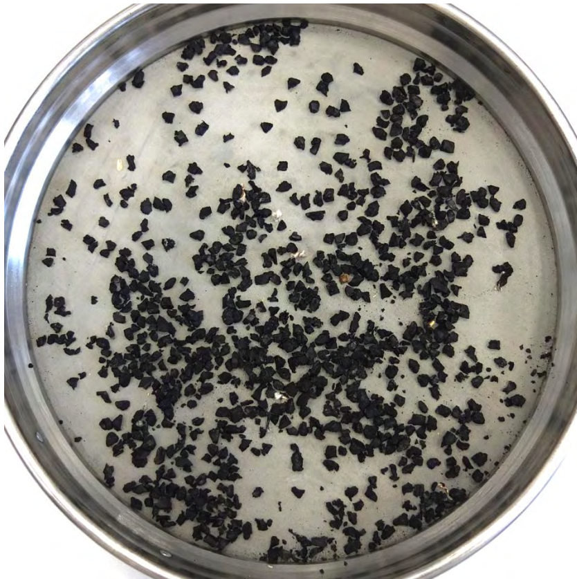
Abbildung 53: getrocknetes Material auf Sieben; Flotation des Grobgranulats; Versuchsreihe mit verschiedenen Volumenströmen des Druckwassers ohne Vorbenetzung durch Ethanol (Volumenstrom: 0,639 l/min)
