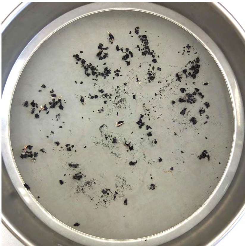
Abbildung 59: getrocknetes Material auf Sieb; Flotation des Grobgranulats; Versuchsreihe zur Verweilzeit; Schaumprodukt 2 entstanden zwischen 3 und 6 Minuten
