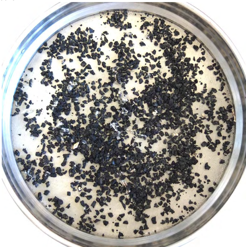
Abbildung 50: getrocknetes Material auf Sieben; Flotation des Grobgranulats; Versuchsreihe mit verschiedenen Volumenströmen des Druckwassers (Volumenstrom: 0,639 l/min)
