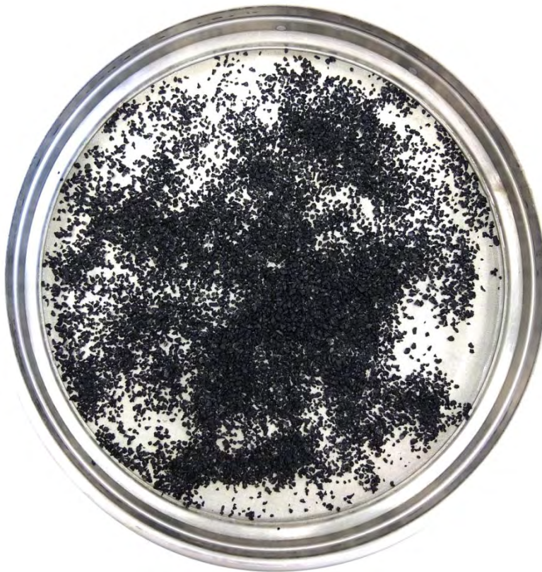
Abbildung 44: getrocknetes Material auf Sieben; Mittelgranulat der Versuchsreihe mit verschiedenen Granulaten
