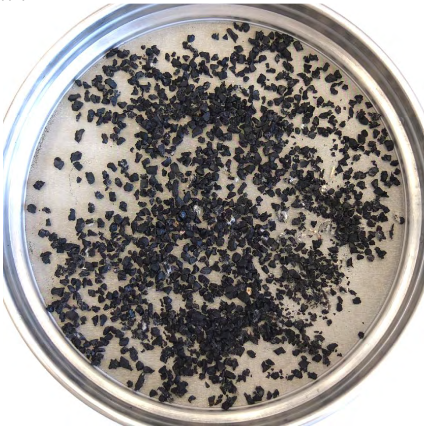
Abbildung 47: getrocknetes Material auf Sieben; Flotation des Grobgranulats; Versuchsreihe mit verschiedenen Konzentrationen an Tensid; (Tensidkonzentration 0,0972 g/l)
