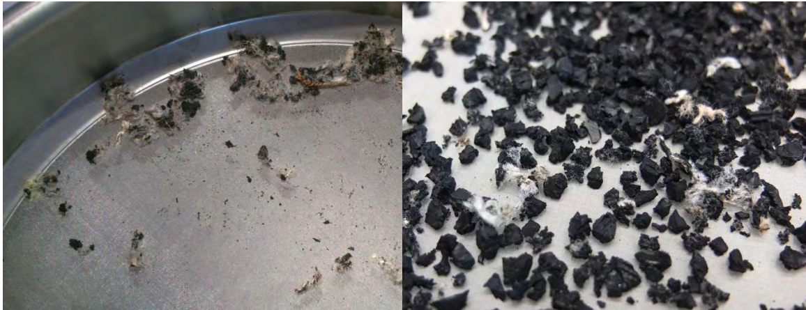
a) b) Abbildung 32: Bilder des Grobgranulats; a) Schaumprodukt, b) Rückstand
