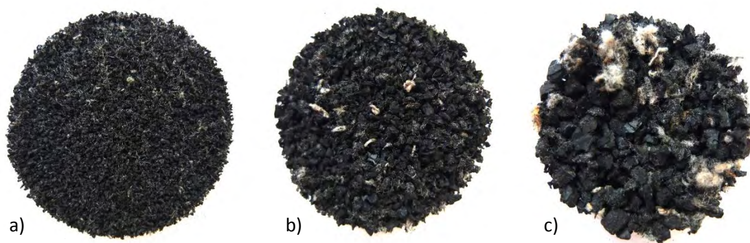
Abbildung 12: Ausgangsmaterial a) Feingranulat b) Mittelgranulat c) Grobgranulat
