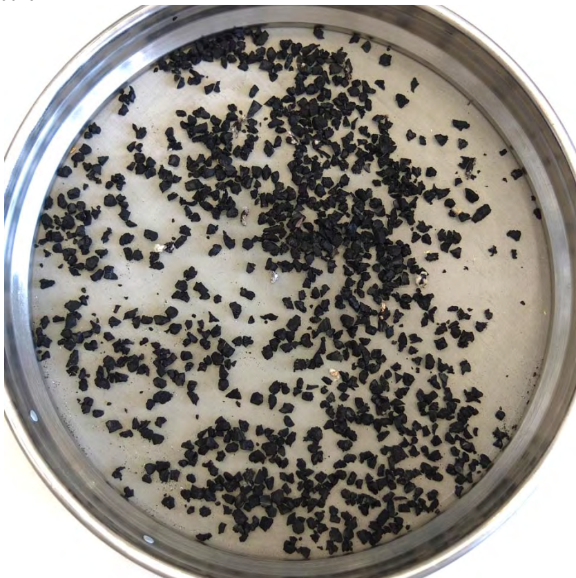
Abbildung 54: getrocknetes Material auf Sieben; Flotation des Grobgranulats; Versuchsreihe mit verschiedenen Volumenströmen des Druckwassers ohne Vorbenetzung durch Ethanol (Volumenstrom: 0,795 l/min)
