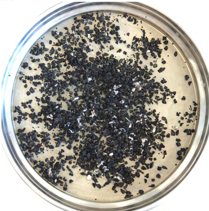
Abbildung 56: getrocknetes Material auf Sieben; Flotation des Grobgranulats; Versuchsreihe mit verschiedenen Überdrücken des Druckwassers (Überdruck: 3,8 bar)
