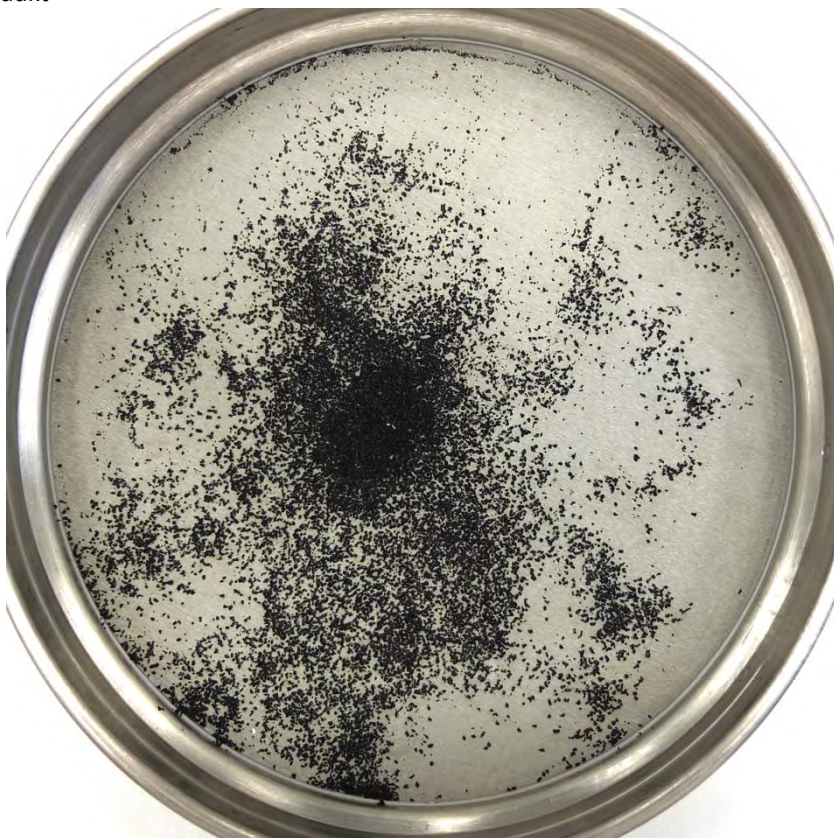
Abbildung 43: getrocknetes Material auf Sieben; Feingranulat der Versuchsreihe mit verschiedenen Granulaten
