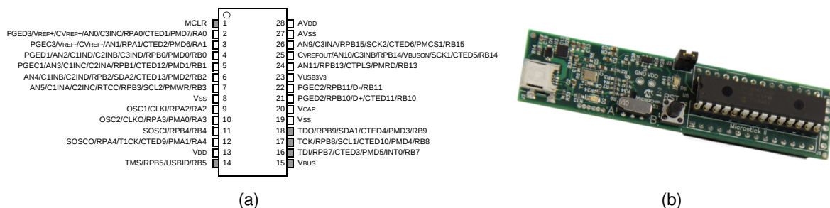
Abbildung 5.19: Darstellung der Pin Konfiguration des PIC32MX2XX und des Entwicklungsboards Microstick 2.
