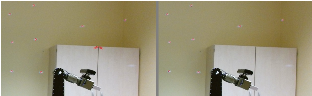
Abbildung 8: Links: Ungefilterte Aufnahme mit sporadisch auftretenden Merkmalen. Rechts: Gefilterte Aufnahme.
