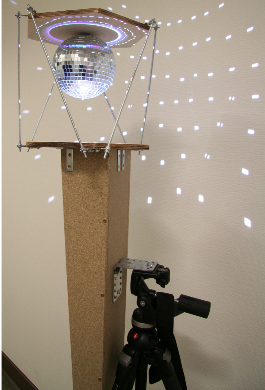
Abbildung 29: Montage auf dem Stativ mittels Schnellwechseladapter
