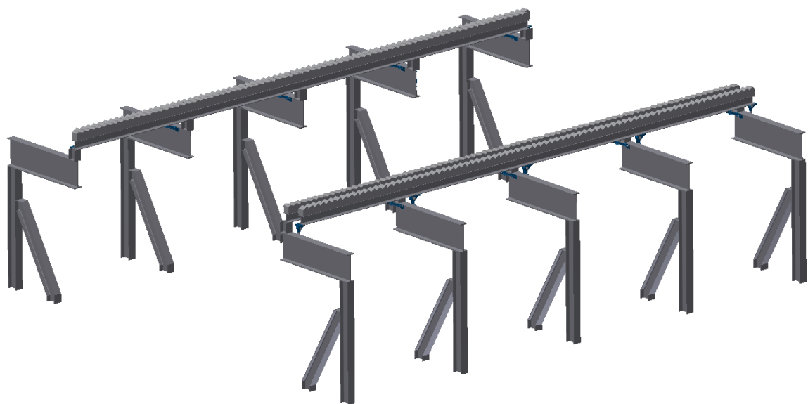
Abbildung 7: Konstruktionsentwurf des Gegenstrombetts
