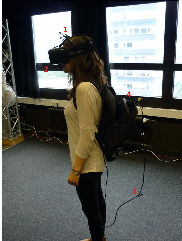
Abbildung 5.8: Eine komplett ausgerüstete Probandin mit einem passiven Target für das Trackingsystem (1) und der Oculus Rift DK2 (2), welche über HDMI und USB (3) an eine mobile Workstation angeschlossen ist (4).
