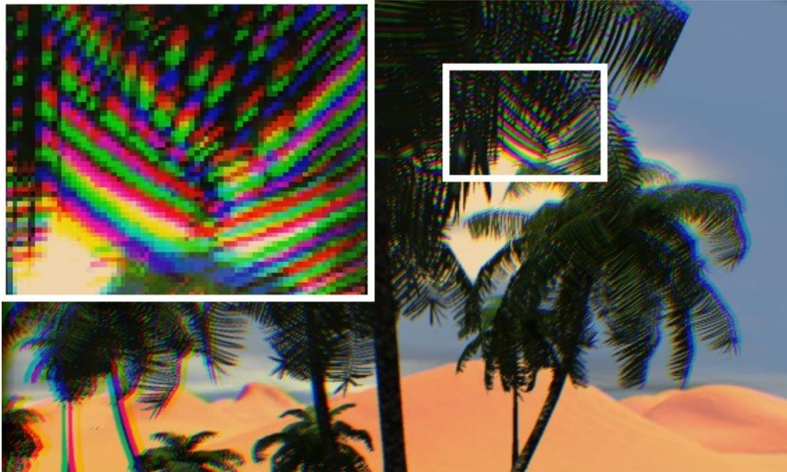
Abbildung 4.1: Vergrößerter Ausschnitt des markierten Bildbereichs auf der Oculus Rift DK2 ohne Brechung durch die Linsen.
