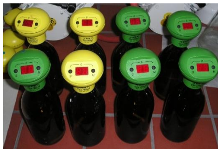
Abbildung 13: 510 ml – Messflaschen mit OxiTop® -Messkopf
