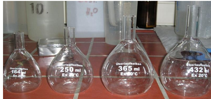
Abbildung 12: Überlaufkolben in den Größen 164 ml; 250 ml; 365 ml und 432 ml (von links nach rechts)
