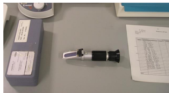
Abbildung 2: Messung der Salinität mit dem Refraktometer
