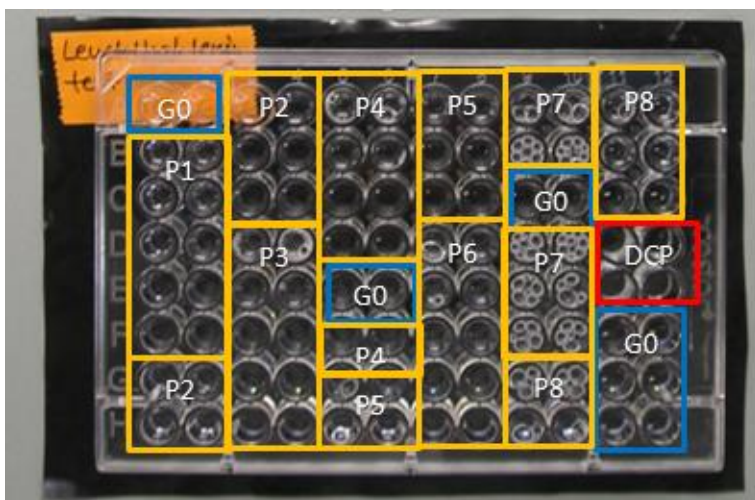
Abbildung 3: Pipettierschema auf der 96-Well-Mikrotiterplatte
