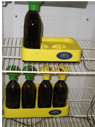
Abbildung 14: Messflaschen auf Magnetrühern im Thermoschrank
