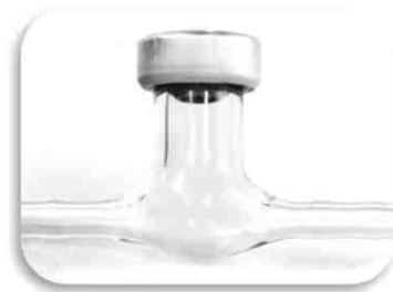
Abb.3-5-2: Gasmaus aus Glas. Mit zwei geöffnete Kanälen (links und rechts) und einen geschlossenen mit einem Septum im Aluminiumdeckel. [29]
