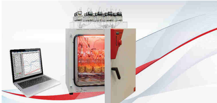
Abb.2-6-8: Biogas-Batch-Gärsystem mit automatischen Gasmessung über MilliGascounter. [17]
