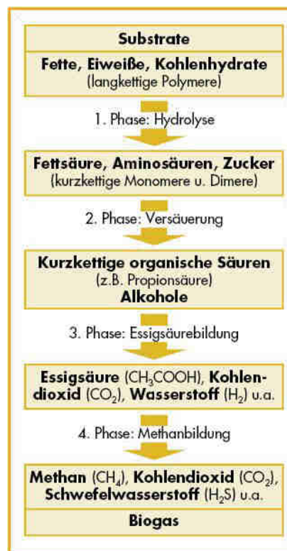
Abb. 2-1: Schematische Darstellung des anaeroben Abbauprozesses. [31]
