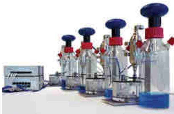
Abb.2-6-6: Automatisches Gasmessung von einem Biogas-Batch-Gärsystem über „Yieldmaster“ von Bluesens. [16]
