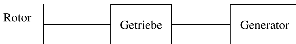
Abbildung 2.12: Maschinenhaus-Schema (grob): Senvion 5M
