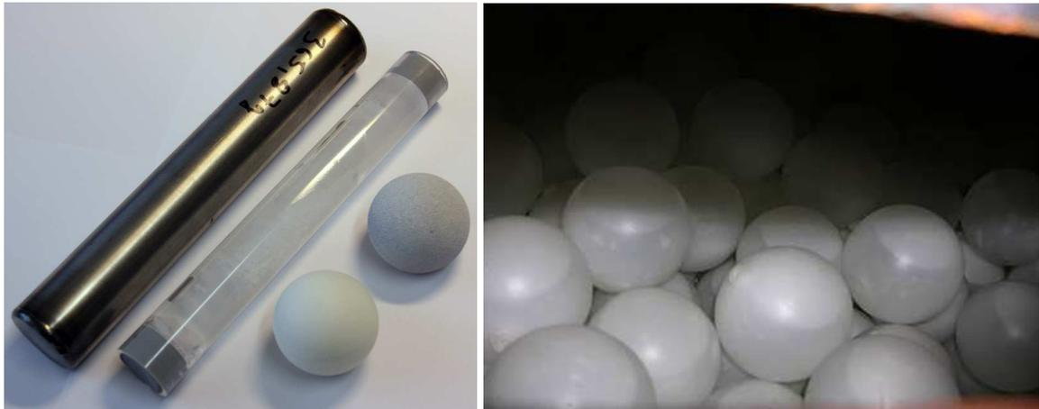
**Abbildung 2.12 - Links: verschiedene Makrokapselvarianten [23], rechts: Kugelschüttung in einem PCM-Speicher [24]**
