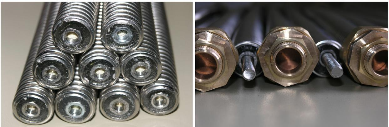
**Abbildung 3.11 - Links: Wellrohre mit Epoxidharzverschluss und eingelassener DN 8 Mutter, rechts: Verschlussarten beider Wellrohrenden**
