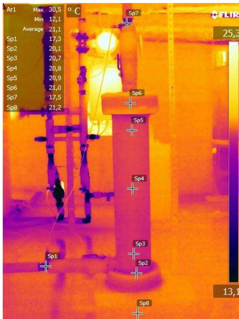
Abbildung 3.18 - Thermographieaufnahme des Speicherprototyps
