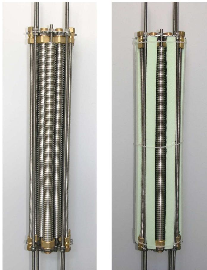
Abbildung 3.10 - Links: Speicherpatrone, rechts: Speicherpatrone mit Styrodurprofilen
