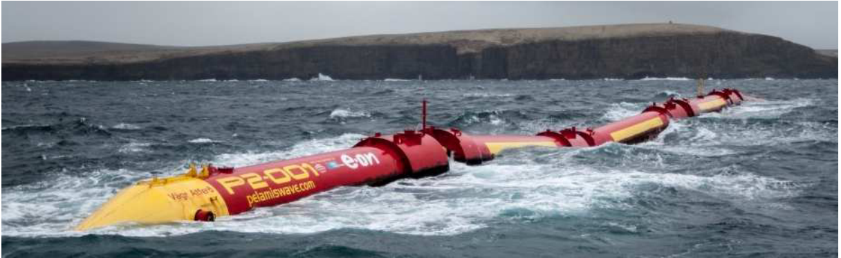
Abbildung 2: Pelamis (Seeschlange) im EMEC Test vor Schottland [6]
