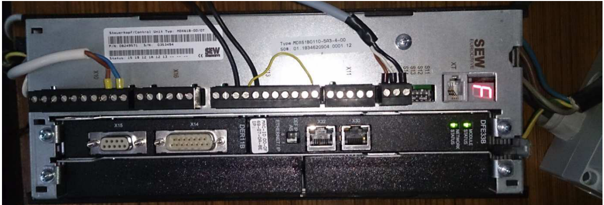
Abbildung 4: Anschlussmöglichkeiten des DFE33B
