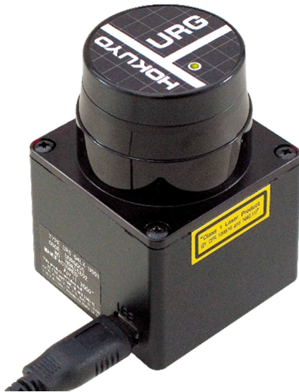
Abbildung 2-5: Lasersensor URG-04LX von der Firma Hokuyo
