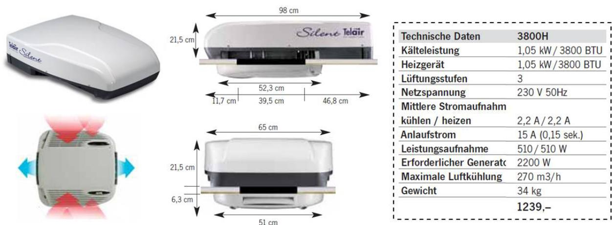
Abbildung 47: Klimaanlage Silent 3800H, [66]
