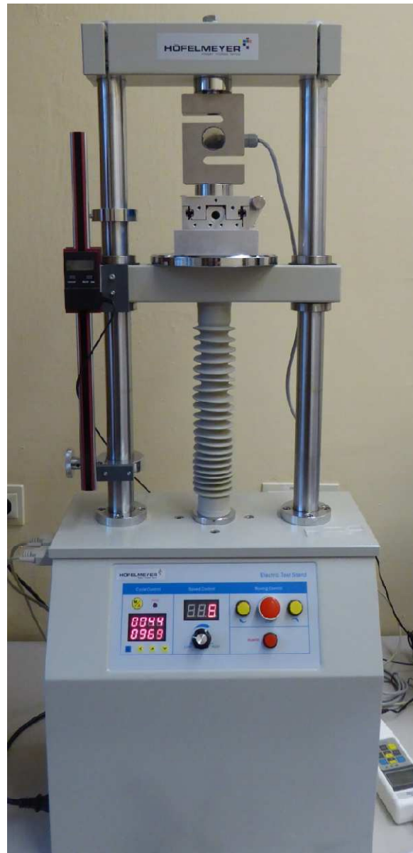
Abbildung 54: Versuchsaufbau mit Justierung des Längenmessgerätes und der Verfahrensgeschwindigkeit
