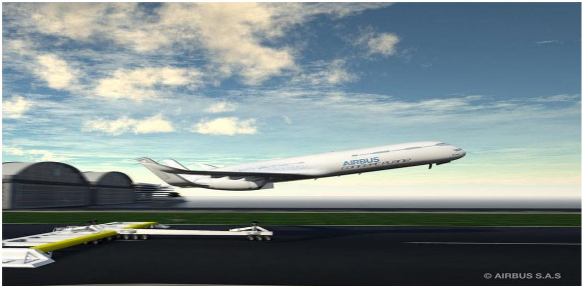
**Abbildung 6.3 : Flugzeugstart mit externen Starthilfen**
