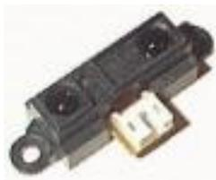
Abbildung 2.10: Entfernungssensor Sharp GP2D12
