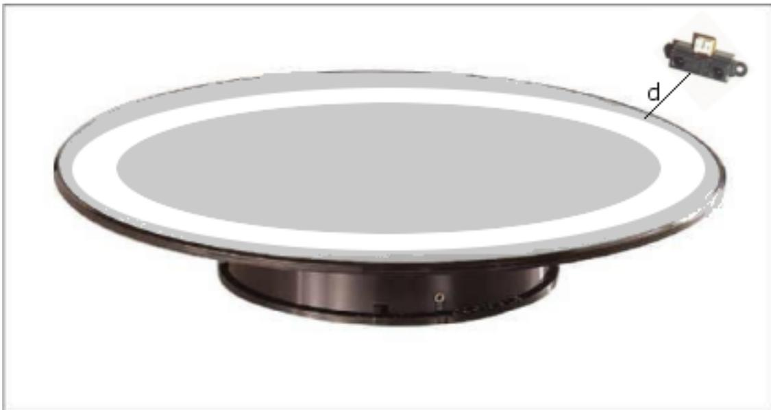
Abbildung 2.9: Abtastbereich des Sensors
