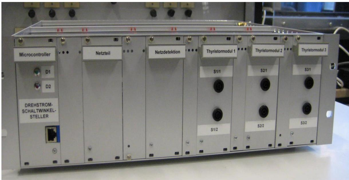
Abbildung 7: Schaltwinkelsteller
