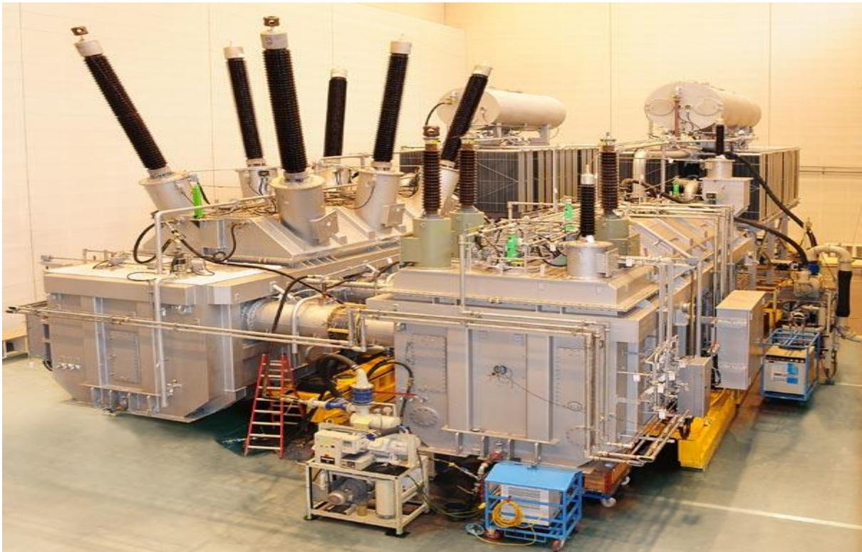
Abbildung 75: 600 MVA Querreglertransformator von der Firma Siemens
