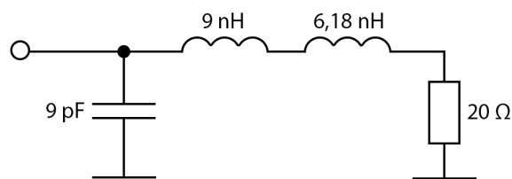
Abbildung 7.4: Schaltung und Dimensionierung des Anpassnetzwerks
