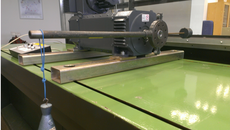
Abbildung 6.13: Vorrichtung zur Messung des Drehmoment-Strom Verhältnisses
