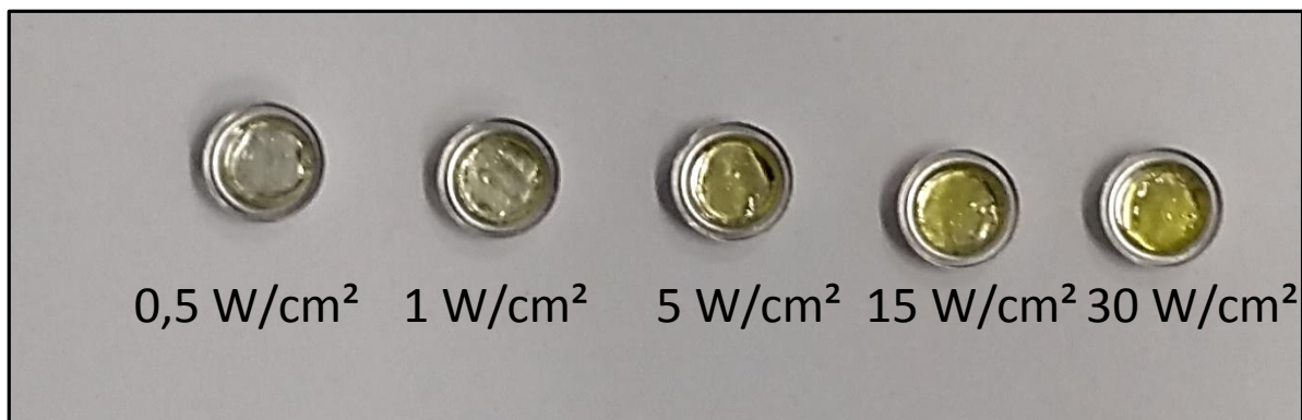
Abbildung 40 Verschieden stark bestrahlte Klebmassen mit MP-Triazin. Die Bestrahlungsintensität der Lampe wurde von 0,5 \text{ W/cm}^2 bis auf 30 \text{ W/cm}^2 erhöht. Deutlich zu erkennen ist die zunehmende Gelbfärbung der Klebmasse.
