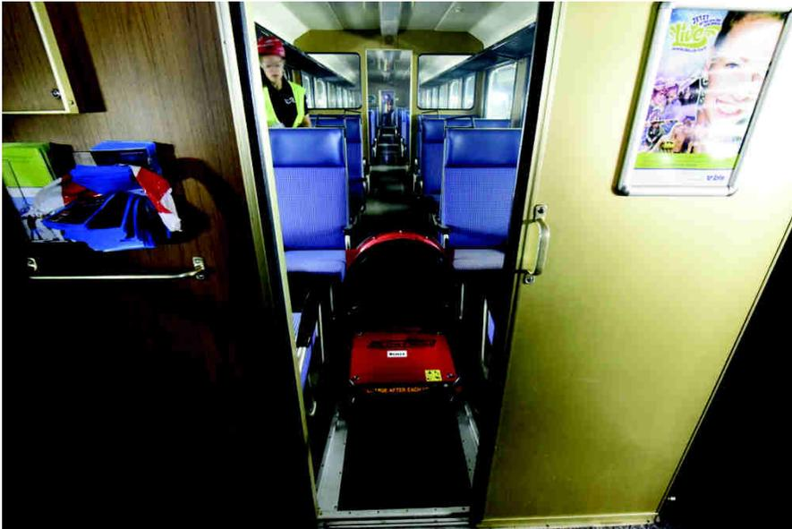
Abbildung 22: Position des Lüfters in Versuch 4. (Grafik: Brauner (2015), eigene Darstellung).
