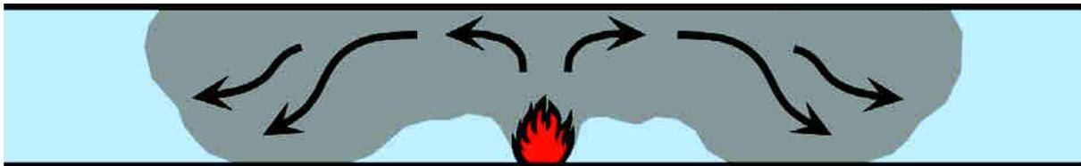
Abbildung 30: Auflösung der Rauchgasschichtung bei Absinken der abgekühlten Rauchgase in einem Tunnel ohne Luftströmung und ohne Ventilation. (Grafik: FKS (n.v.), S. 29).
