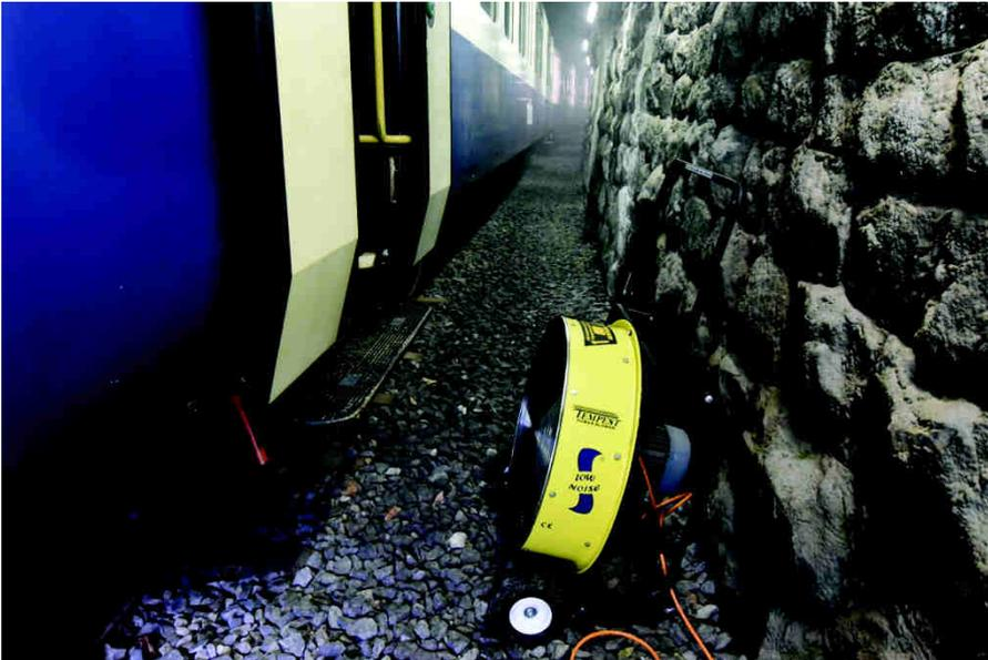
Abbildung 12: Elektrolüfter Power Blower Tempest EV 27-3,0. (Grafik: Brauner (2015), eigene Darstellung).
