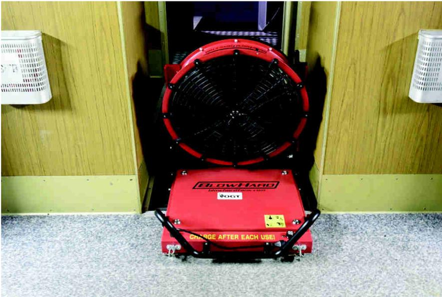
Abbildung 11: Akkulüfter Blowhard Compact Ventilator. (Grafik: Brauner (2015), eigene Darstellung).
