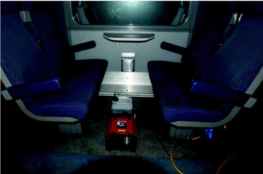
Abbildung 10: Rauchmaschine Firefog 2.400. (Grafik: Brauner (2015), eigene Darstellung).
