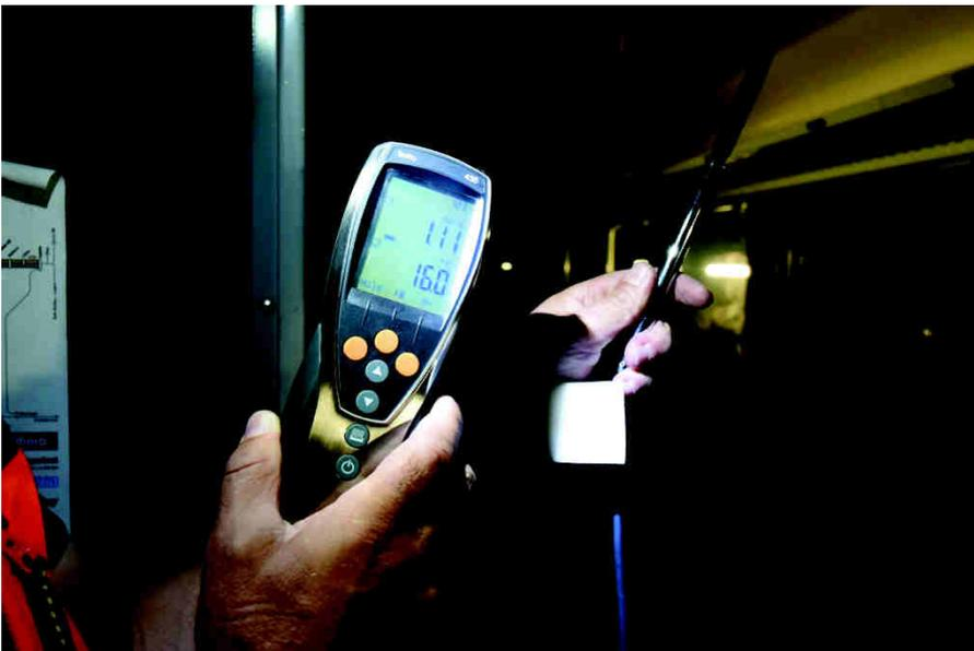
Abbildung 13: Multifunktionsmessgerät testo 435 mit Hitzdrahtsonde. (Grafik: Brauner (2015), eigene Darstellung).
